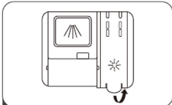
1 Tháo nắp ngăn chứa nước trợ xả bằng cách nhấn tay cầm lên.
